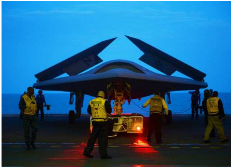
Figure 3 : Drone de combat américain X47B en phase d'expérimentation à bord d'un porte-avion
